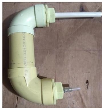
Fig. 11 Filtro de Aire Seco.
