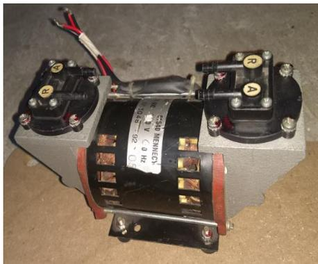
Fig. 12 Compressor de Aerógrafo.
