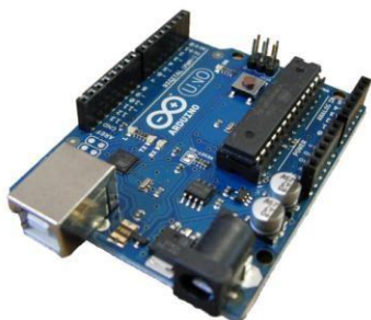
Arduino UNO con microcontrolador en formato DIP formato SMD
