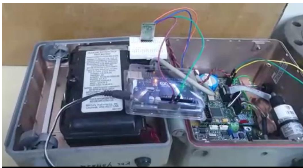
Fig. 12. Implementación Modulo Bluetooth en la Unidad Correctora Mercury-Mini Max
